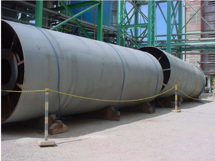
A segunda etapa, que ocorreu na zona de calcinação e de descarga, a carcaça do Calcinador apresentava desgastes acentuados, além da impregnação excessiva de carepas de material refratário fundido, que não saíram com o jato **SA 2 1/2**.
