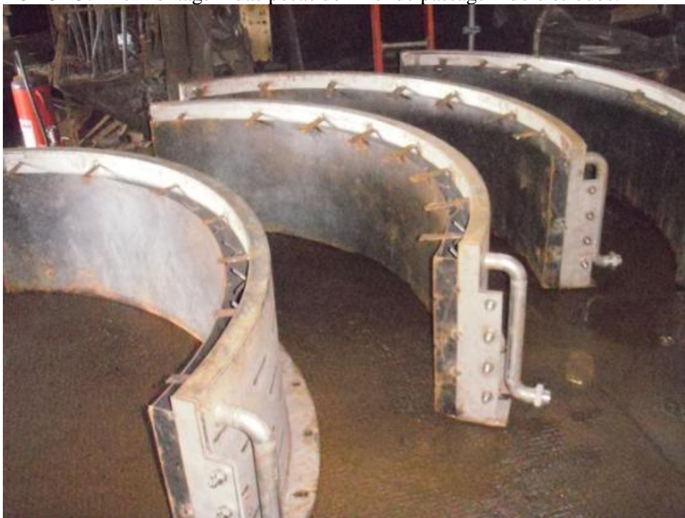
FOTO 24: Peças com formas prontas para serem concretadas.
