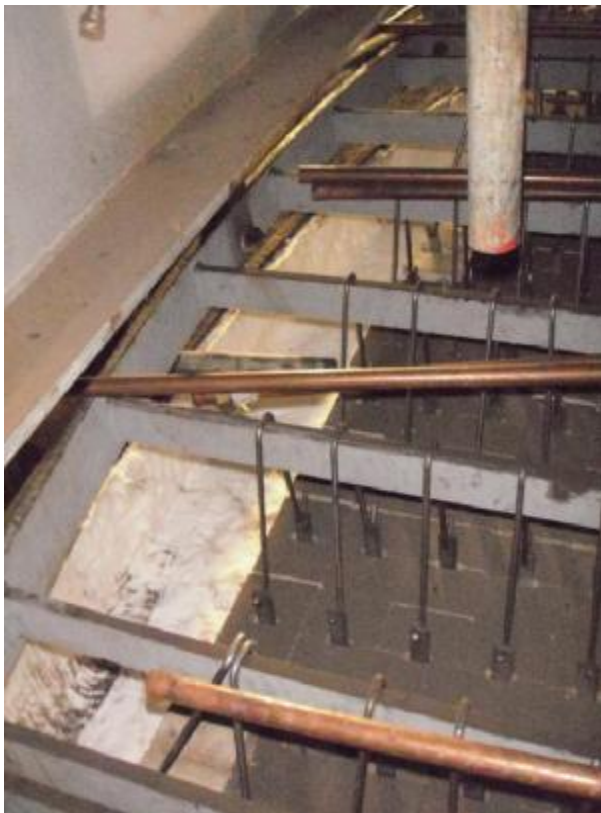
FOTO 15: Detalhe da junção dos tijolos pendurados e costado.
