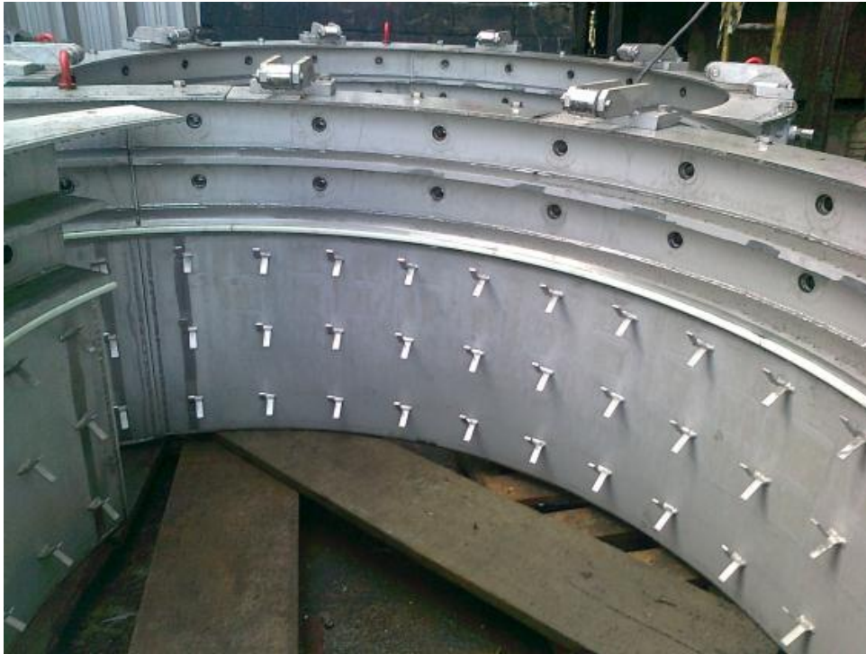
FOTO 23: Pré-montagem das peças do Anel de passagem do eletrodos.
