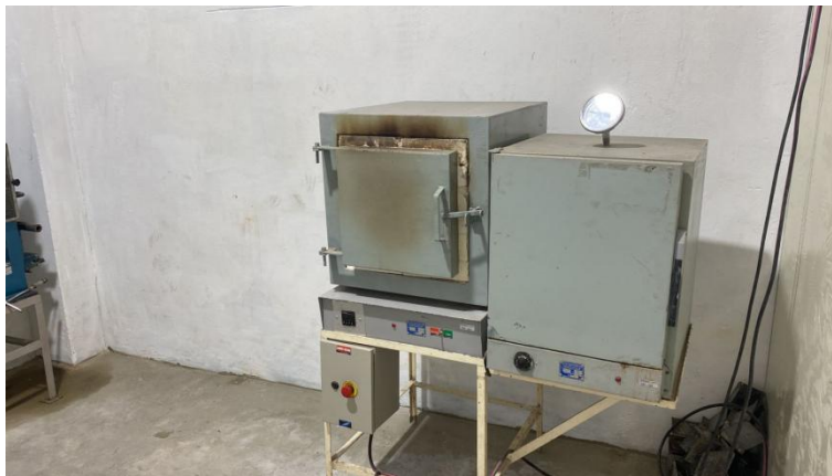
Imagem 31 - Conjunto estufa e forno do laboratório Risoterm utilizados para fazer a secagem e queima dos corpos de prova conforme ficha técnica do fabricante.
