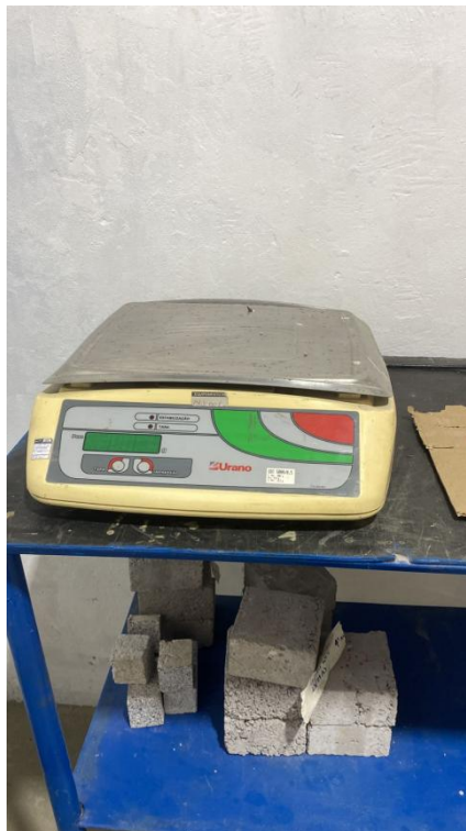
Imagem 32 - Balança do laboratório Risoterm utilizados para fazer a pesagem dos corpos de prova para ensaio de Massa Específica Aparente (MEA).
