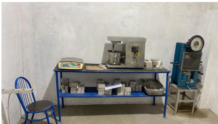
Imagem 33 - Local de armazenamento de corpos de prova no laboratório Risoterm para secagem e queima e posterior execução de rompimento na prensa hidráulica.
