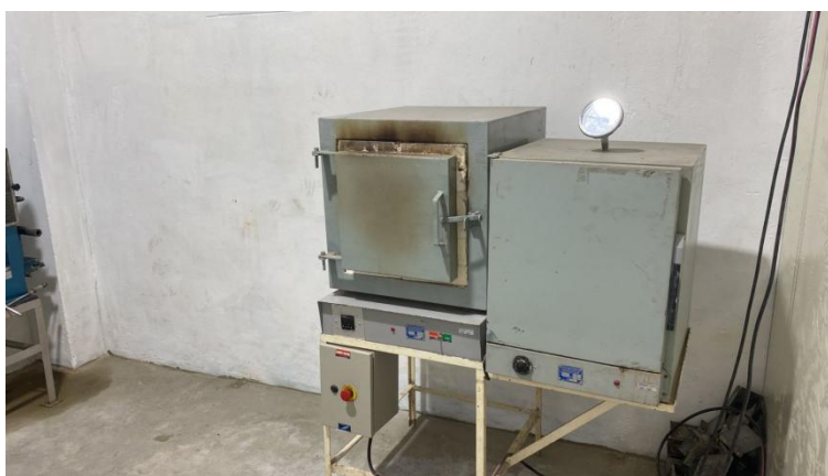
Imagem 28 - Conjunto estufa e forno do laboratório Risoterm utilizados para fazer a secagem e queima dos corpos de prova conforme ficha técnica do fabricante.
