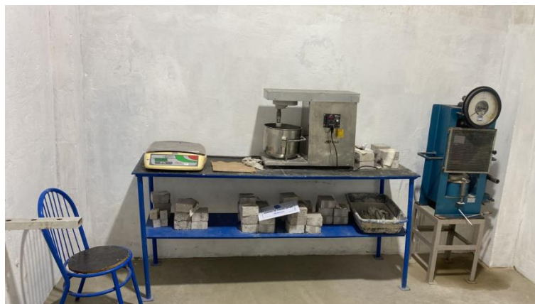
Imagem 30 - Local de armazenamento de corpos de prova no laboratório Risoterm para secagem e queima e posterior execução de rompimento na prensa hidráulica.
