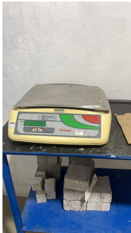
Imagem 29 - Balança do laboratório Risoterm utilizados para fazer a pesagem dos corpos de prova para ensaio de Massa Específica Aparente (MEA).
