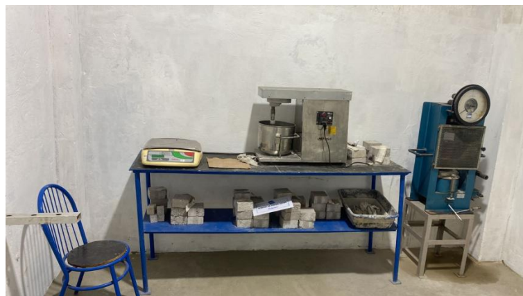
Imagem 21 - Local de armazenamento de corpos de prova no laboratório Risoterm para secagem e queima e posterior execução de rompimento na prensa hidráulica.
