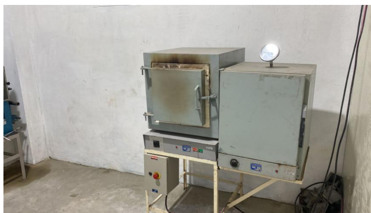
Imagem 19 - Conjunto estufa e forno do laboratório Risoterm utilizados para fazer a secagem e queima dos corpos de prova conforme ficha técnica do fabricante.
