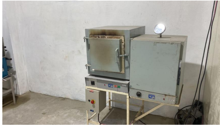
Imagem 22 - Conjunto estufa e forno do laboratório Risoterm utilizados para fazer a secagem e queima dos corpos de prova conforme ficha técnica do fabricante.
