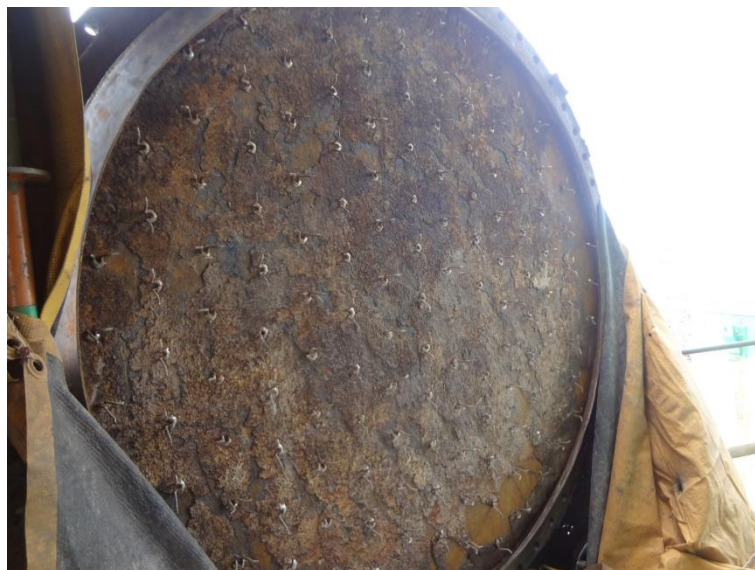
Imagem 20 - Tampa da BV de 74" localizada no regenerador antes da recomposição do refratário.
