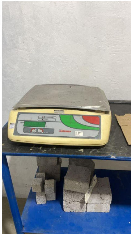
Imagem 23 - Balança do laboratório Risoterm utilizados para fazer a pesagem dos corpos de prova para ensaio de Massa Específica Aparente (MEA).
