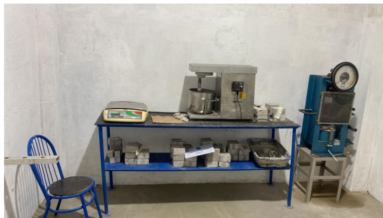
Imagem 24 - Local de armazenamento de corpos de prova no laboratório Risoterm para secagem e queima e posterior execução de rompimento na prensa hidráulica.
