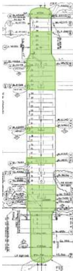
Imagem 1 - Arranjo geral do equipamento E-901 com indicação das regiões onde houve substituição do isolamento.
