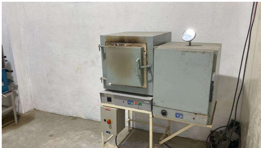
Figura 71 - Conjunto estufa e forno do laboratório Risoterm utilizados para secagem e queima dos corpos de prova conforme ficha técnica do fabricante e orientações das normas Petrobras.
