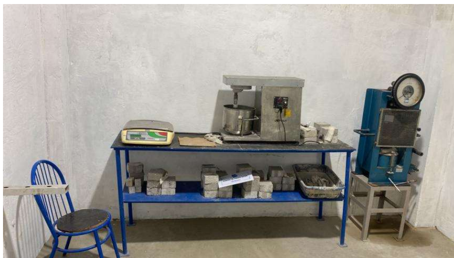
Figura 73 - Local de armazenamento de corpos de prova no laboratório Risoterm para secagem e queima e posterior execução de rompimento na prensa hidráulica.
