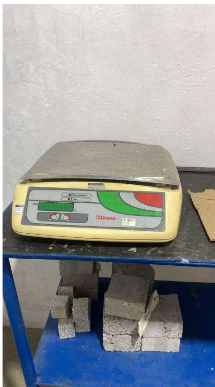
Figura 72 - Balança do laboratório Risoterm utilizados para fazer a pesagem dos corpos de prova para ensaio de Massa Específica Aparente (MEA).
