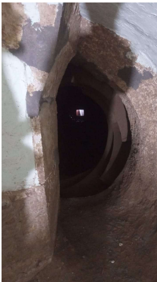
Figura 6 – Reparo nas falhas do refratário da meia lua com concreto de pega química.
