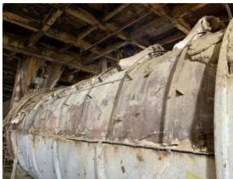
Imagem 3 - Tubulão após a remoção do isolamento na geratriz superior externa. Detalhe da presença dos perfis de fixação do isolamento e pinos de ancoragem.
