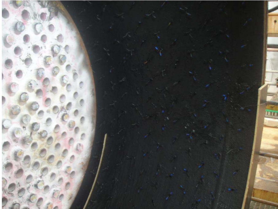
Imagem 9 - Carretel da GV-3601 com massa anticorrosiva
