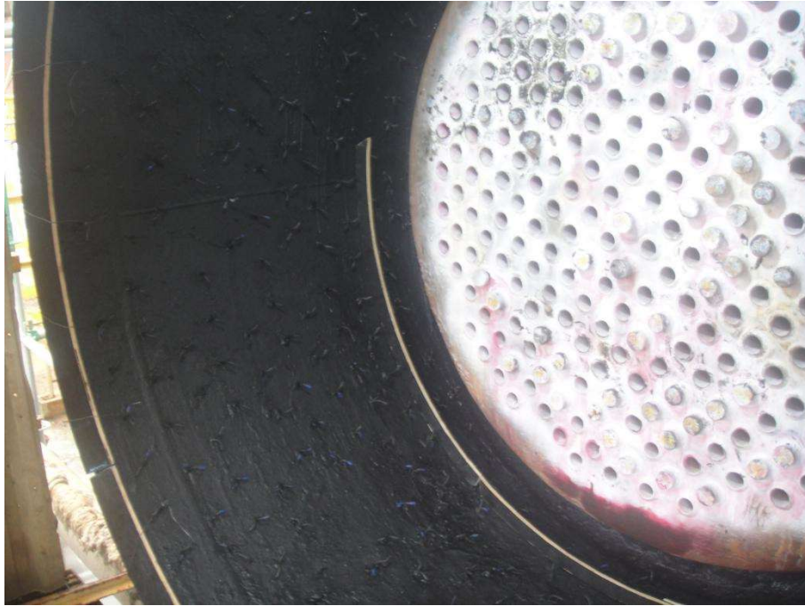
Imagem 7 – Carretel da GV-3601 com massa anticorrosiva
