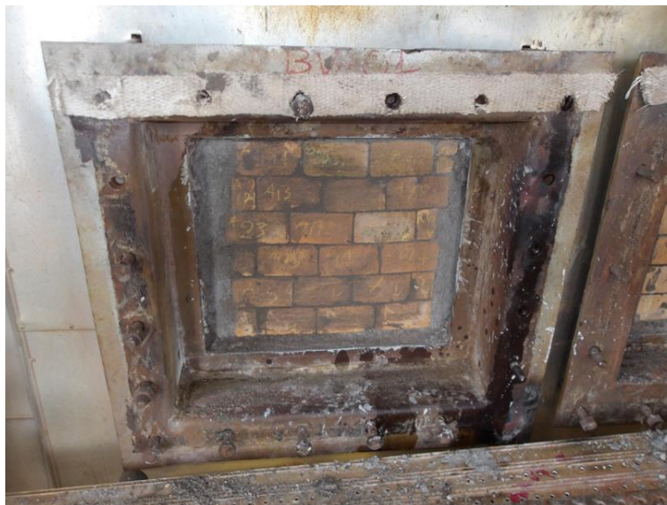
Imagem 17 – Detalhe do fechamento das BV's com tijolos.
