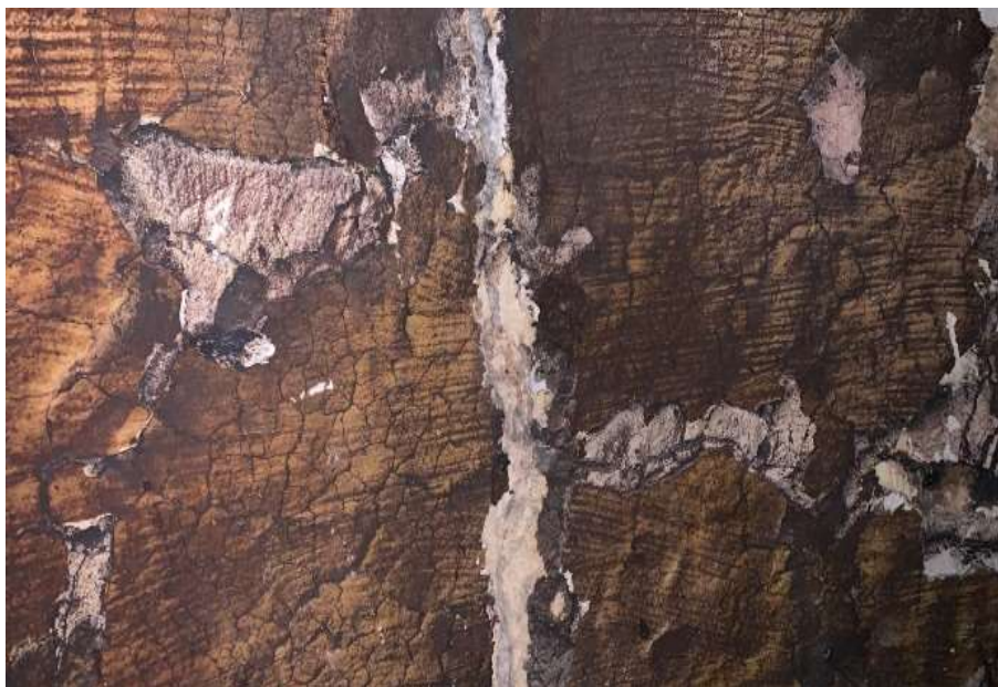
Imagem 17 - Situação do costado da câmara de combustão antes do reparo.
