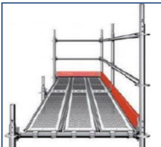
Figura 07: Detalhe do guarda corpo e rodapé
