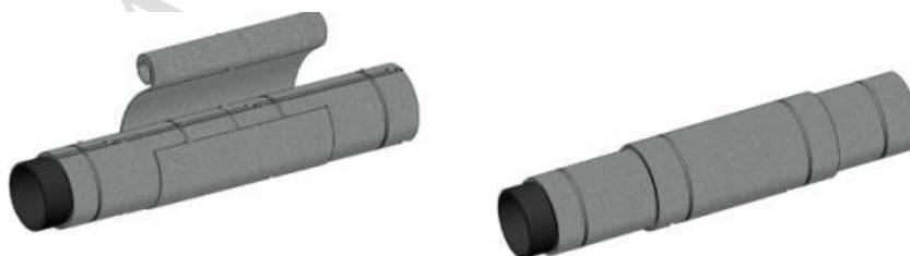
Figura 02: Enrolamento duplo de Cryogel em tubulações.
