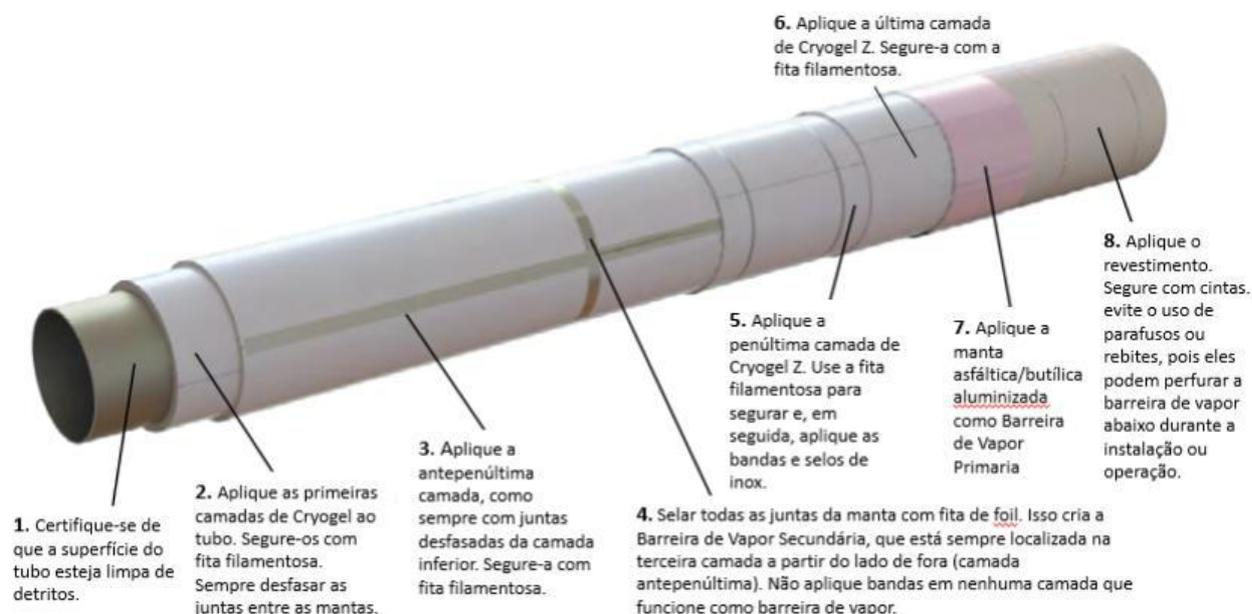
Figura 06: Aplicação de Cryogel em tubulações e equipamentos.
