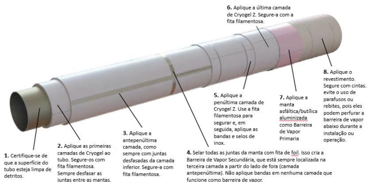
Figura 06: Aplicação de Cryogel em tubulações e equipamentos.
