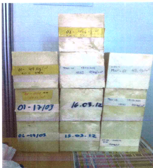
Foto 20 – Corpo de prova disponibilizado diariamente durante a execução dos serviços na UPGN.
