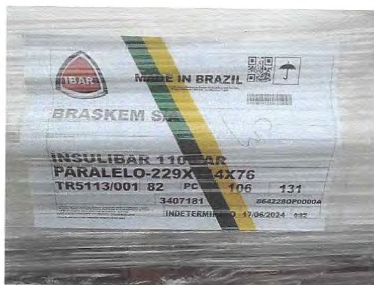
Figura 5 - Identificação dos materiais na frente de serviço: Insulibar AR Paralelo 229 x 114 x 76
