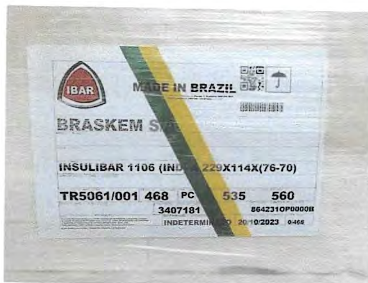
Figura 4 - Identificação dos materiais na frente de serviço: Insulibar AR Arco 1 229 x 114 x (76-70)
