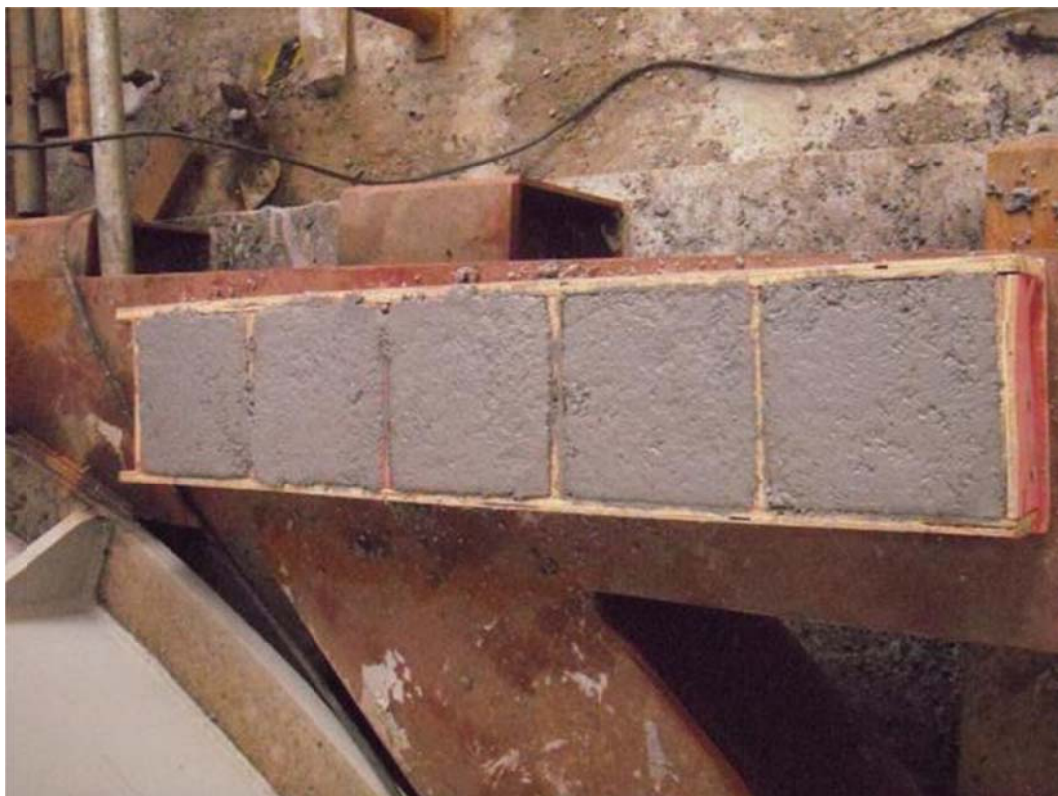
FOTO 05: Corpo de prova da segunda etapa de concretagem.
