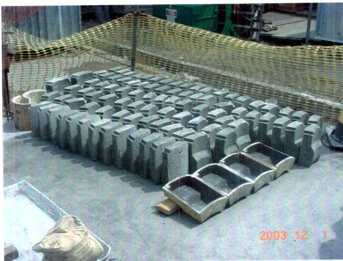
Fabricação dos blocos secundários dos queimadores
